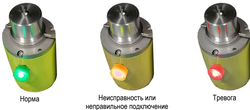
Рисунок 1 Работа индикаторного светодиода – фонаря
